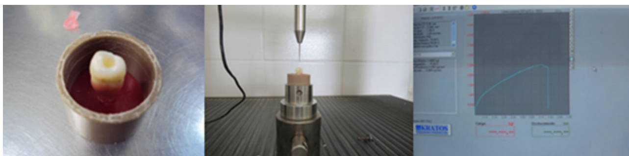
Figura 1. - Arranjo experimental estabilizado e submetido a teste de compressão na máquina de ensaios universal Kratos.
