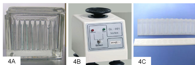
Figura 4A: Etapa laboratorial para fixação do material em solução álcool/éter 1:1. Figura 4B: Centrifuga utilizada nas etapas laboratoriais da técnica de base líquida. Figura 4C: Filtros para eliminação de material residual, como debris, hemáceas e muco.
